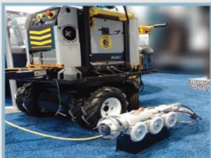
Görüntüleme Kameraları ( $\varnothing 800\text{mm}$  -  $\varnothing 1500\text{mm}$ )
