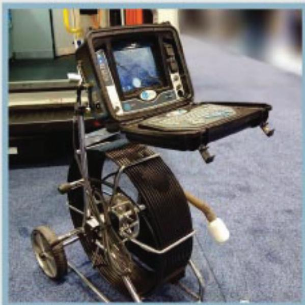
El Kamerası ( $\varnothing 50\text{mm}$  -  $\varnothing 200\text{mm}$ )
